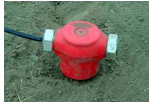
受振器設置状況 4.5Hz 速度型ジオフォン
