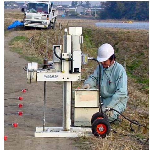
スウェーデン式サウンディング試験 「ジオカルテ」による併用調査 調査深度 4.0~8.75m。
